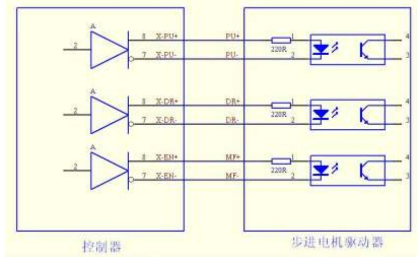
注意：差分接法必须接到控制器或者运动控制卡的差分输出口上，而不能把差分信号的正端或者负端当作共阳接法的控制信号来接(此种接法容易导致控制位置不准或者丢步)。
