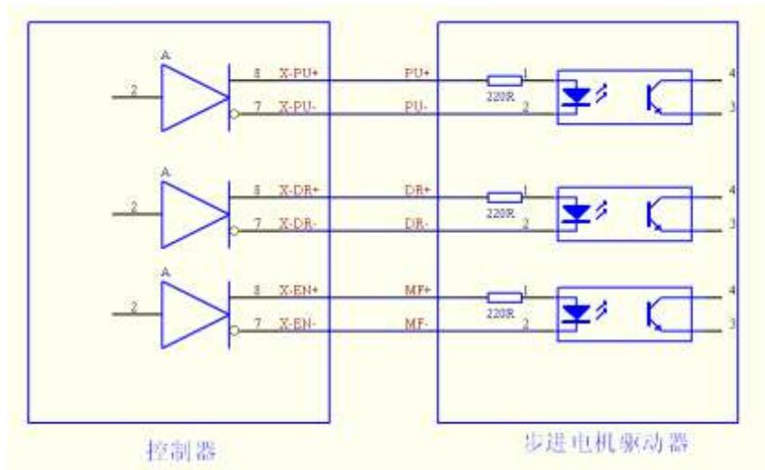
注意：差分接法必须接到控制器或者运动控制卡的差分输出接口上，而不能把差分信号的正端或者负端当作共阳接法的控制信号来接(此种接法容易导致控制位置不准或者丢步)。
